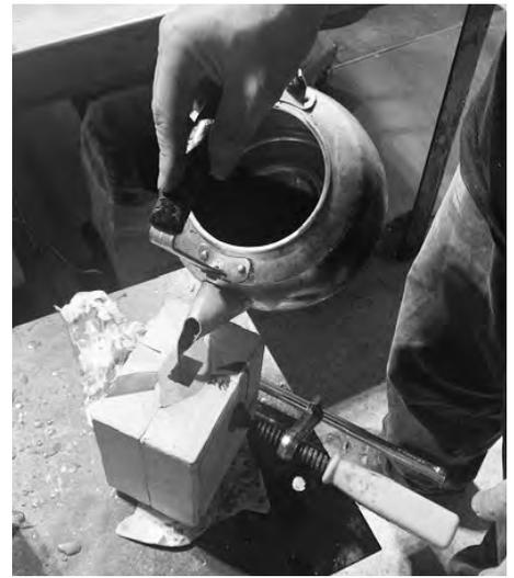
[写真33] 型へロウの流し込み
