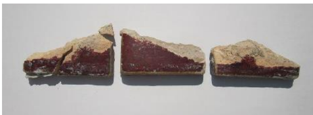
写真 4-12 タイルサンプル・モルタル除去
